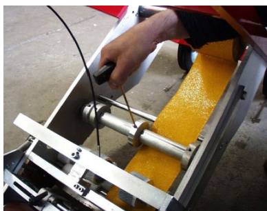
Abb. 2: Justieren der oberen Folienführung Folienführung
