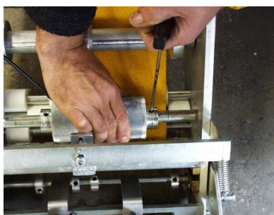
Abb. 3: Justieren der Vorschubrolle in die Folienmitte
