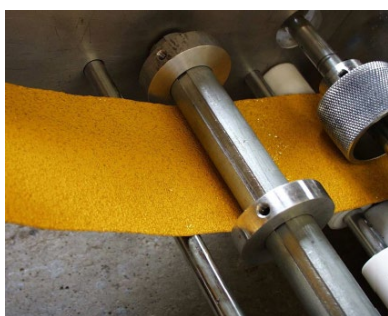
Abb. 1: Einfädeln der Folie
