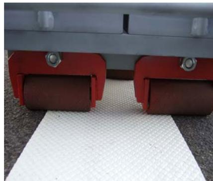
Beide Geräte sind speziell für 3M Fahrbahnmarkierungsfolien mit druckaktivierbaren Klebern konstruiert.
